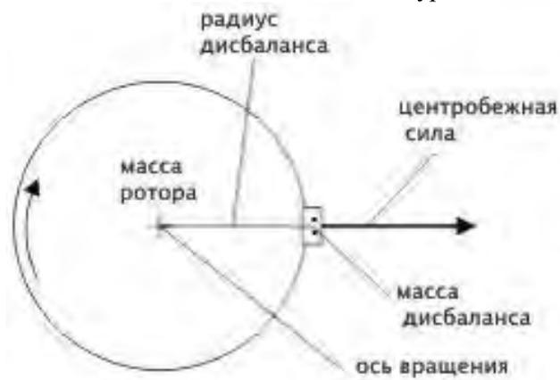
Рис. 1 Схема балансирующего устройства
