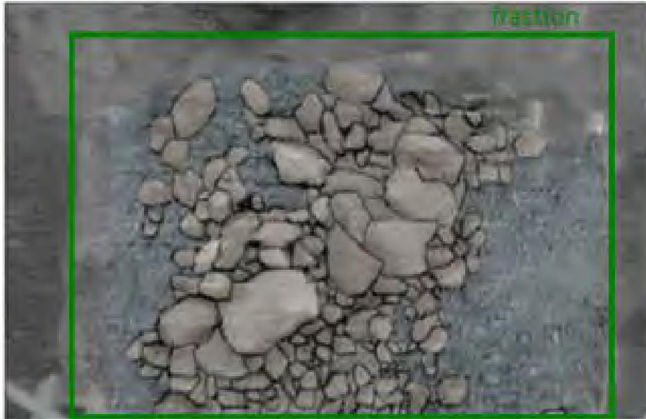
Рисунок 1 – процесс распознавания гранул в породе
