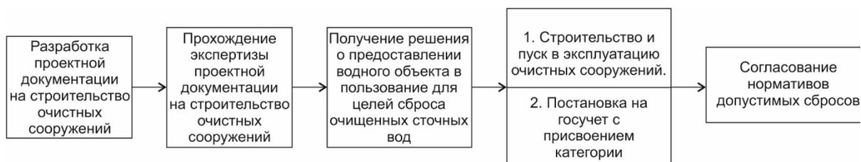
Рисунок 1 – Порядок действий предприятия в части согласования нормативов допустимого сброса при проектировании, строительстве и вводе в эксплуатацию очистных сооружений
