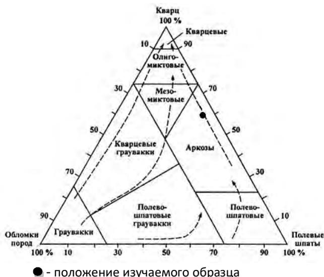
Рисунок 3 – Классификация песчано-алевритовых пород по их минерально-петрографическому составу
