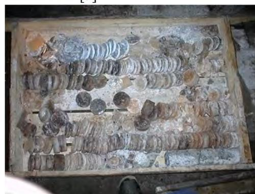
Рисунок 1 – Дискование в лаборатории (а) и в натуре (б)
