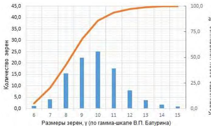
Рисунок 2 – Кумулятивная кривая и гистограмма распределения зерен по фракциям изучаемого образца
