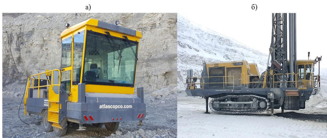
Рисунок 1. Система дистанционного управления: а) мобильный центр управления буровым станком на базе прицепа; б) буровой станок PitViper-235
