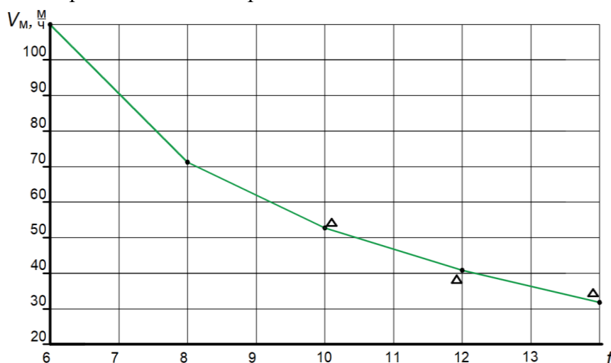
Рисунок 2. Расчетная зависимость механической скорости бурения станков Sandvik D50KS ( v_m ) от крепости горных пород (f) в условиях ПАО «Ураласбест»; \Delta – экспериментальные данные
