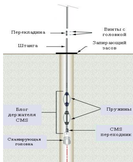
Рисунок 5. Комплект для вертикальной установки (VIP) удерживает CMS в устойчивом положении и по центру при его опускании в вертикальную скважину [6].
