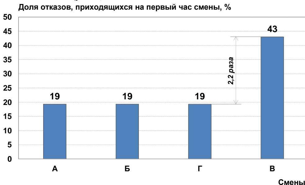
Рисунок 3. Распределение доли отказов, приходящихся на первый час по сменам (группам машинистов выходящих в одну смену).
