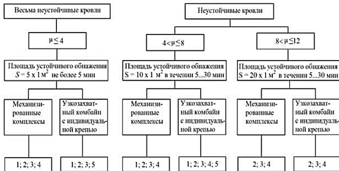
Рисунок 3. Рекомендуемые мероприятия по повышению устойчивости кровли: 1 – защитная пачка угля; 2 – опережающее химическое анкерование; 3 – нагнетание вяжущих составов; 4 – частичная затяжка кровли; 5 – сплошная затяжка кровли
