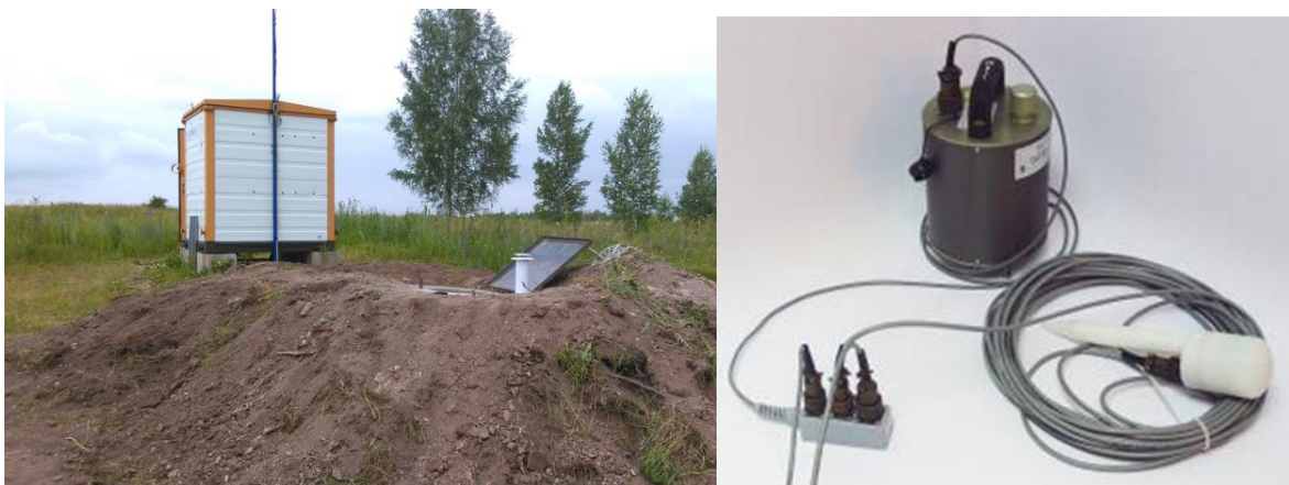
Рисунок 3. Сейсмическая станция на местности и ее оборудование
