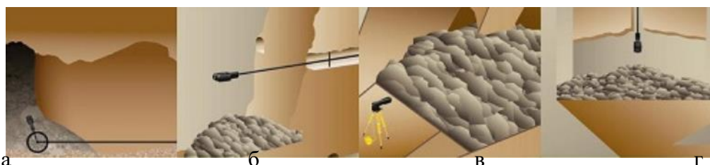
Рисунок 3. Способы установки системы а) подкатная тележка, б) карбоновые штанги и мачты, в) штатив, г) вертикальная установка [4].
