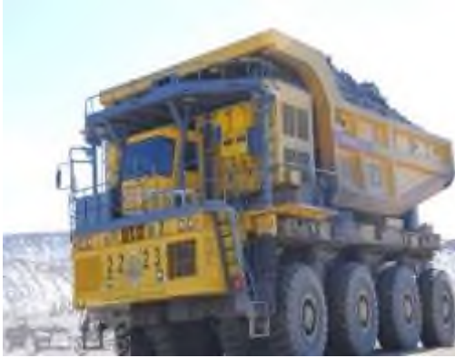
Рис. 2. Карьерный самосвал WTW 220E с грузоподъемностью 220т
