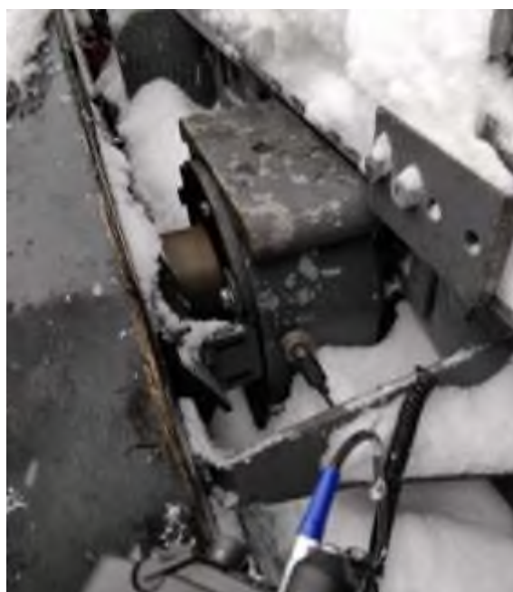
Рисунок 3 – Установка датчика на подшипниковом узле.
