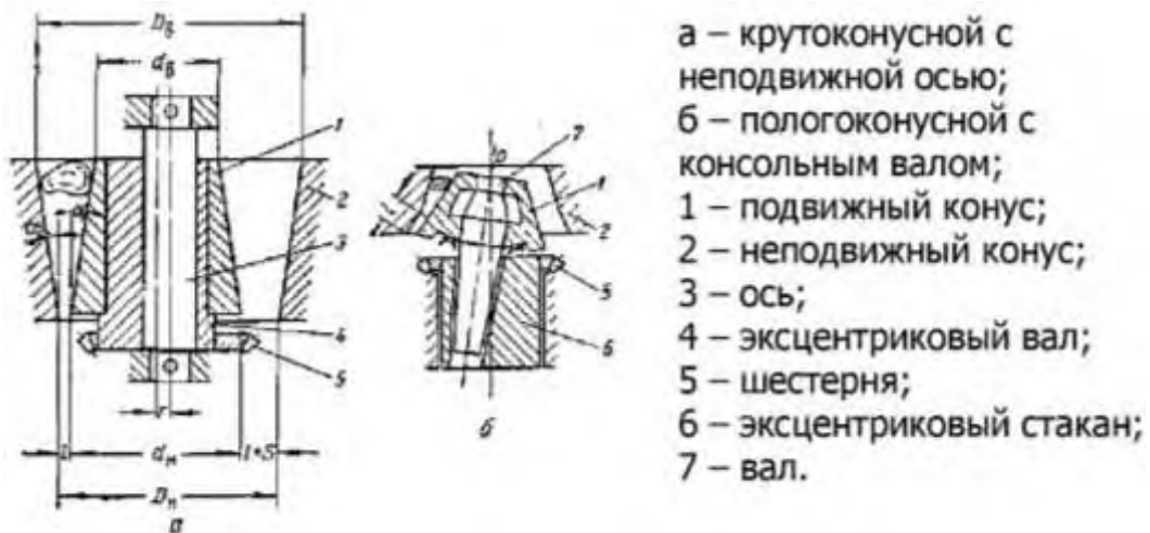
Рис.1.1 – Схема стандартной конусной дробилки.
