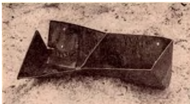
Рис. 1. Деформация ковша скреперно-бункерной машины с разрывом и развитием трещин вследствие однократного попадания на пень
