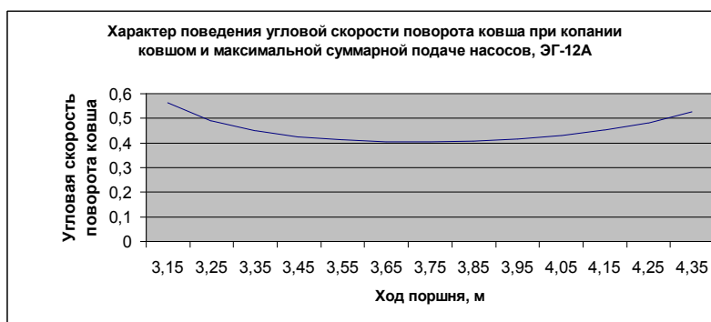
Рис. 3 Изменение угловой скорости ковша ( \text{в } \text{с}^{-1} )
