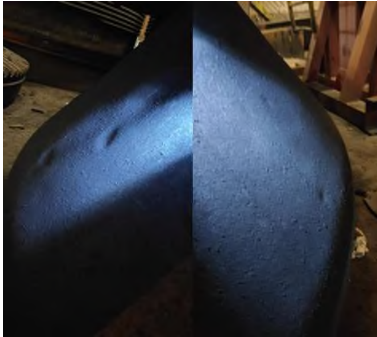
Рисунок. 1. Следы прохождения недробимого тела через зону дробления на броне дробилки
