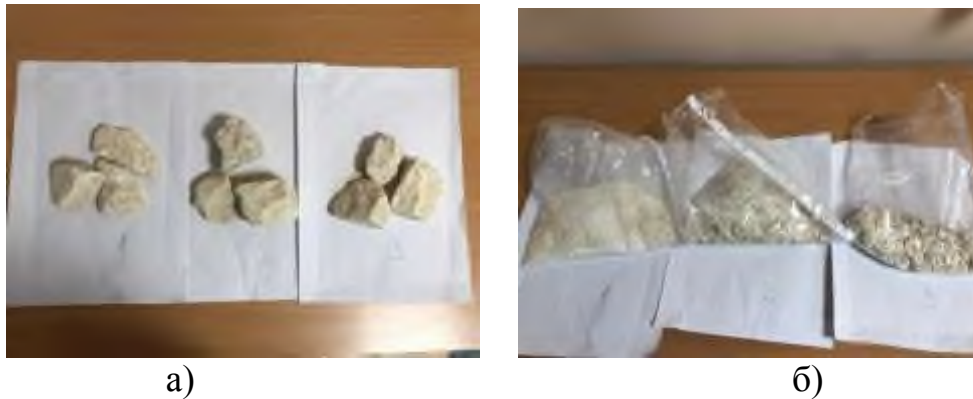
Рис. 2. Исходный мрамор (а) и после дробления (б)
