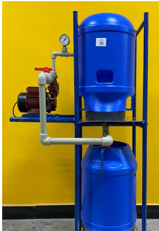
Рисунок 4 – Фотография установки по модифицированию (эмульгированию) флотореагентов
