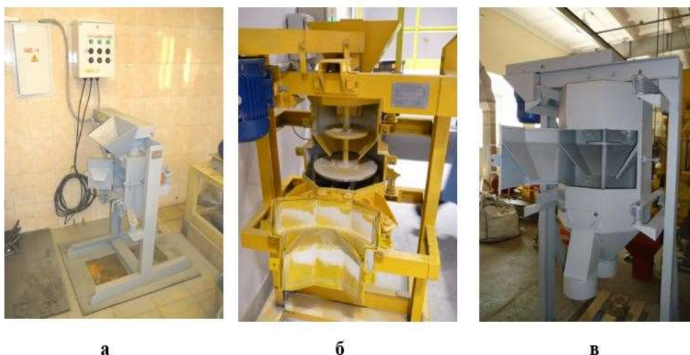
Рисунок 4 – Дисковые сократители в отделении пробоподготовки: а – СОД-2-100В; б – СОД-2-300В; в – СОД-2-400В
