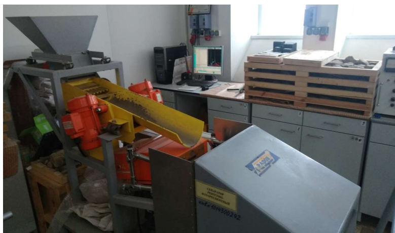
Рисунок 1 – Рентгенорадиометрический сепаратор СРФ1-100Л разработки ООО «Радос»
