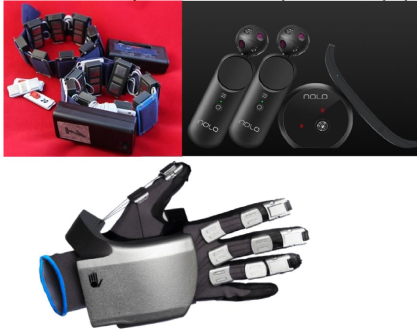
Рисунок 1 – Внешний вид устройств VR: левый верхний - электромиографический браслет MySpark, правый верхний - система трекинга Nolo CV1, нижний Senseglove Nova.
