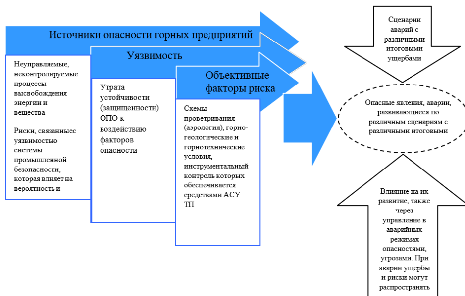
Рисунок 1 – Модель опасных явлений и аварий, которые могут возникнуть на шахтах в результате невыполнения требований охраны труда и промышленной безопасности
