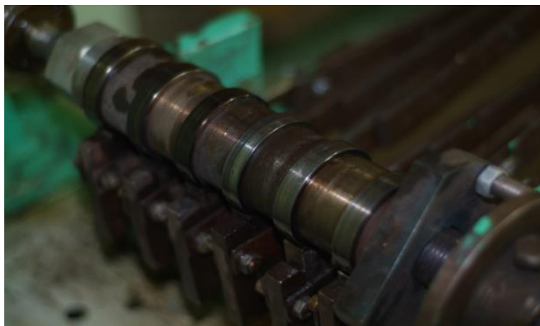
Рисунок 2 – Стенд для моделирования абразивного изнашивания
