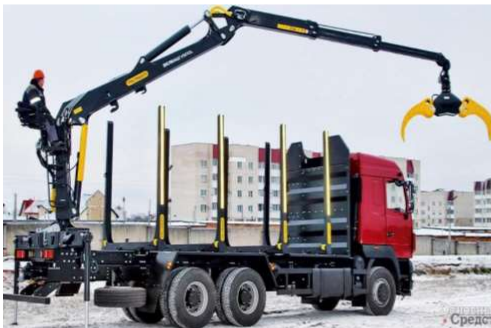
Рис. 1. Кран-манипулятор класса ВЕЛМАШ-VM10L86
