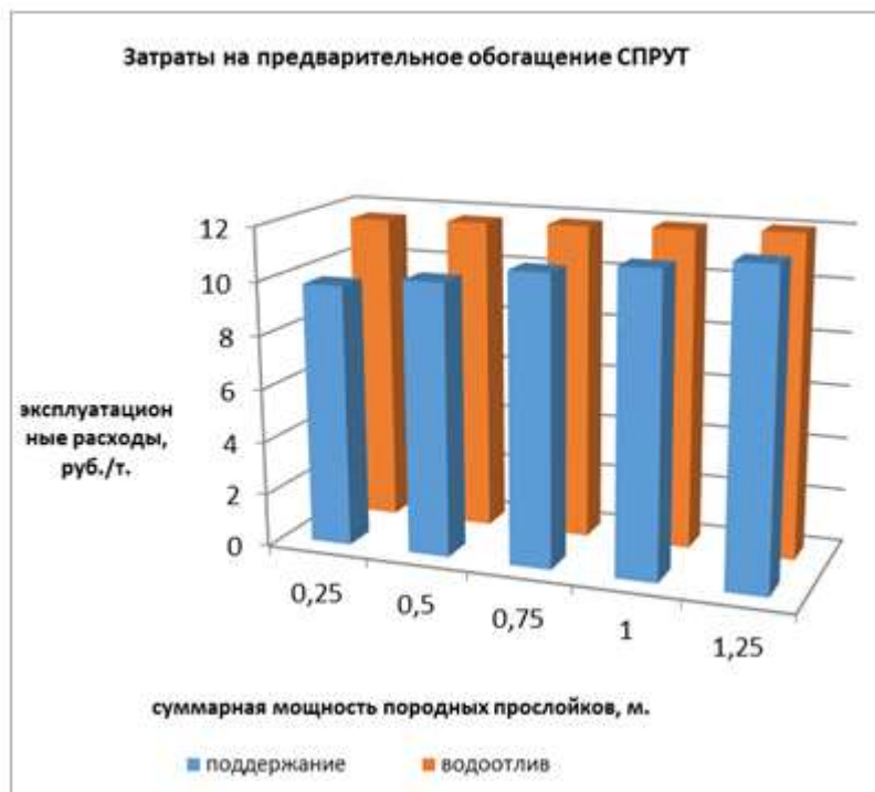
Рис.4. Гистограммы распределение затрат на обогащение СПРУТ при различных технологических процессах: а), б), в)
