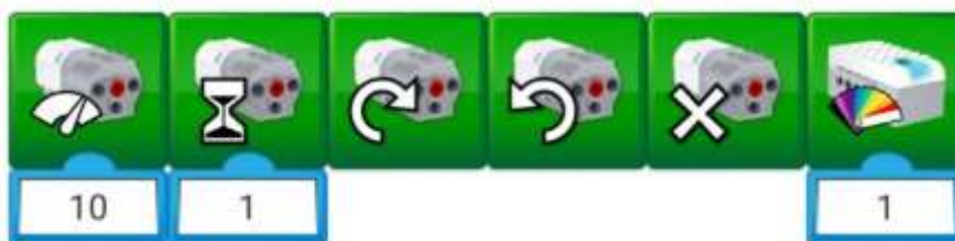
Рис. 1. Блоки управления мотором и индикатором смартхаба
