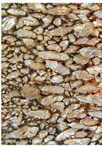
Рисунок 3 – Осадки катодной меди, полученные при использовании графитового анода (увеличение в 100 раз)
