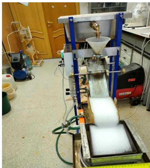
Рисунок 1 – Пенный сепаратор подготовлен к работе
