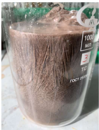
Рисунок 3 – Процесс вымораживания пробы оборотной воды, где: а – замороженная проба; б – проба после оттайки
