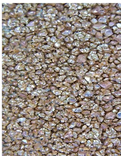
Рисунок 3 – Осадки катодной меди, полученные при использовании графитового анода (увеличение в 100 раз)
