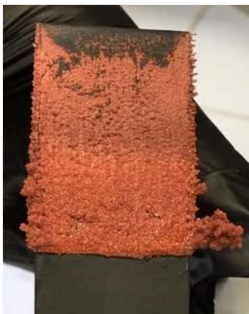
Рисунок 4 – Катодная медь после электроэкстракции с использованием графитового катода
