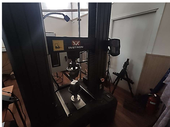
Рисунок 1 – Универсальная электромеханическая испытательная машина INSTRON 5982
