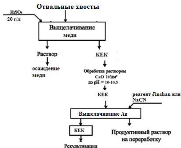
Рисунок 1 – Принципиальная схема выщелачивания
