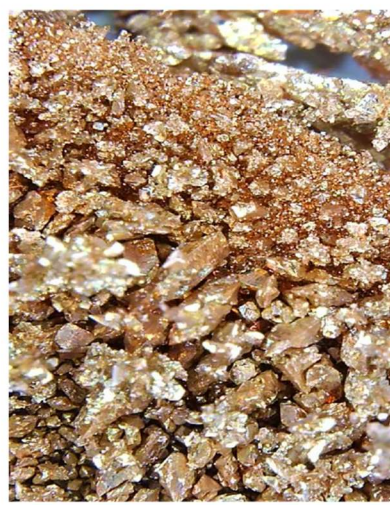
Рисунок 3 – Осадки катодной меди, полученные при использовании графитового анода (увеличение в 100 раз)
