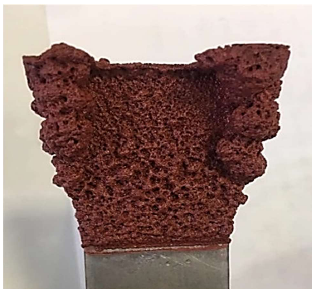
Рисунок 2 – Катодная медь, полученная на титановом катоде за 360 мин
