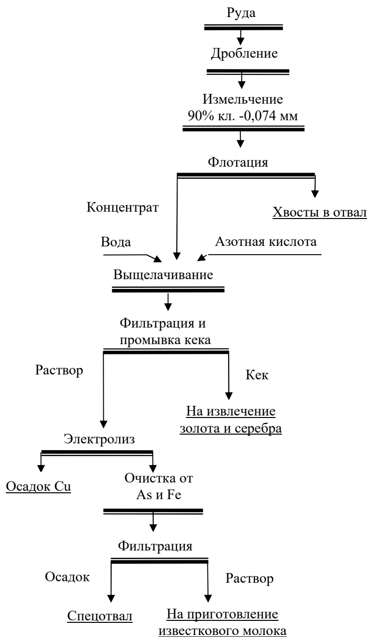
Рисунок 1 – Принципиальная технологическая схема переработки золото-медно-мышьяксодержащей руды месторождения Тарпор
