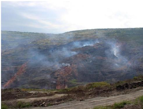
**Рисунок 5 – Коркинский разрез. Самовозгорание руд в борту разреза (г. Коркино, Челябинская область)**
