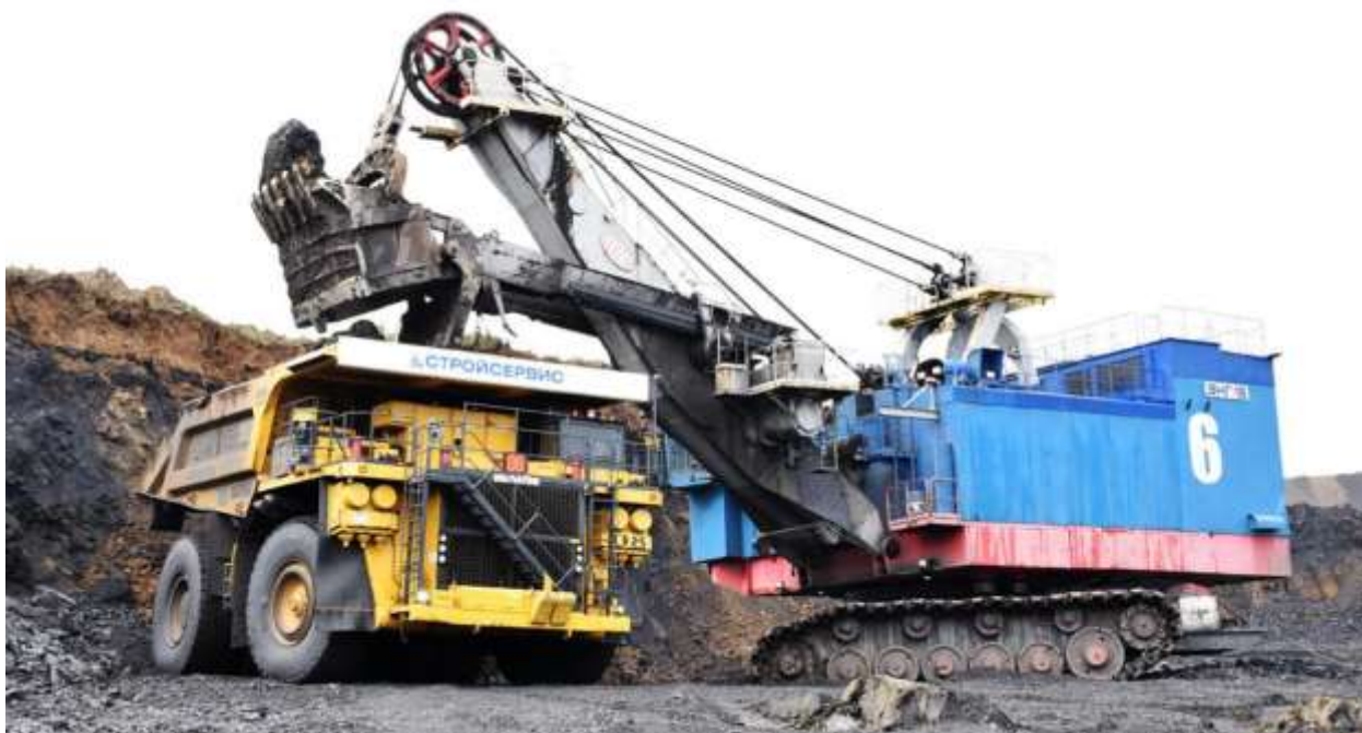
Рис. 2. Экскаватор ЭКГ-18 №6 с ковшом вместимостью 20 м 3 (SAE 2:1) в забое с погрузкой в автосамосвалы 231,2 Komatsu 830E т на разрезе «Березовский» ЗАО «Стройсервис»
