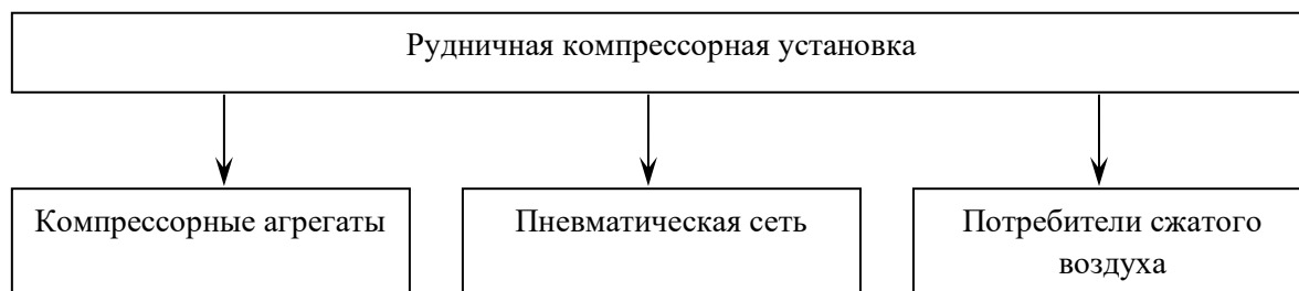
Рисунок 1. Рудничная компрессорная установка, как техническая система
