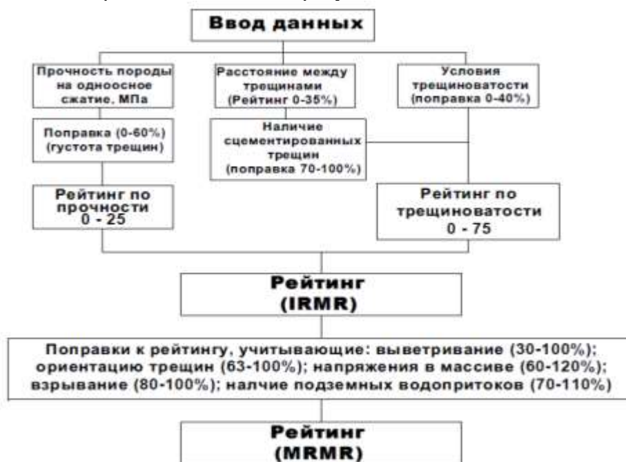
Рисунок 2 – Алгоритм к определению рейтингового показателя MRMR по классификации Д.Лобшира
