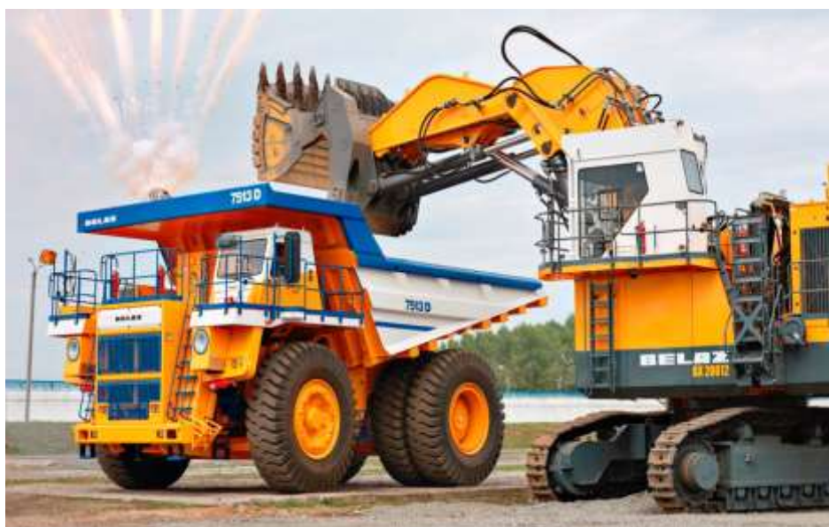
Рис. 4. Карьерный гидравлический экскаватор БелАЗ ВХ-20012 с ковшом 12 м 3 (насыпная плотность в ковше 1,78т/м 3 ), мощность двигателя 1167 л.с., вырывное усилие 770кН
