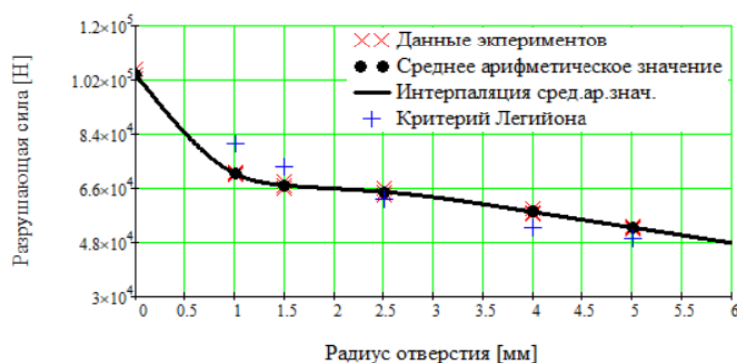
Рисунок 3. Данные испытаний и расчета по связанному критерию для В96Ц1.
