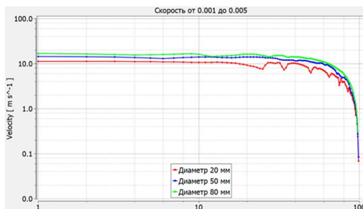
Рисунок 1. Скорость газа по оси скважины для второго варианта притока
