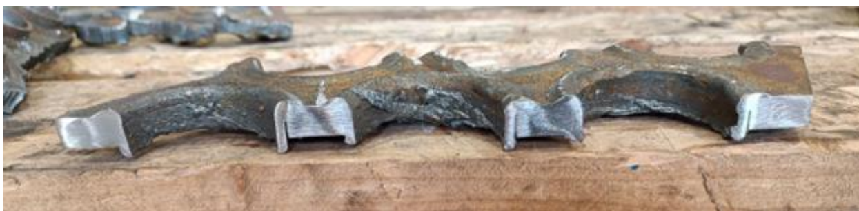
Рисунок 2. Макрошлиф сварного соединения (короткая дуга)
